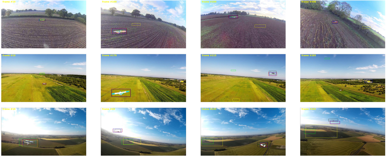
Şekil 3: Oluşturulan veri seti üzerinde literatürdeki yöntemlerin sonuçlarının karşılaştırılması (sırasıyla siyah, kırmızı, mavi, yeşil ve sarı renkli çerçeveler, nesnenin gerçek pozisyonu, ÖHT, ÖHT-Tiny, CSRT ve KCF yöntemlerini temsil etmektedir).
